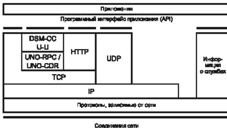
Рисунок 4 — Структура стека протоколов интерактивного канала
