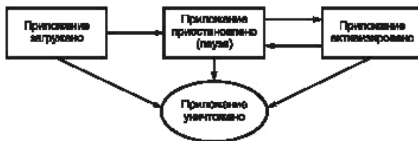
Рисунок 5 — Модель состояний виртуальной машины Xlet
