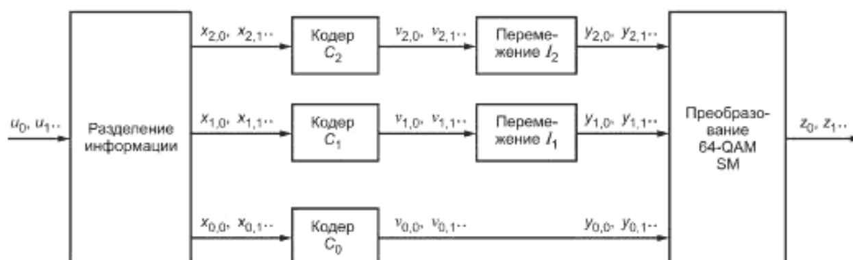
Рисунок 29 — Многоуровневое кодирование с 3 уровнями для SM
