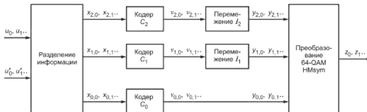
Рисунок 30 — Многоуровневое кодирование с 3 уровнями для HMsym
