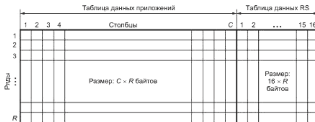
Рисунок 22 — Структура фрейма FEC
