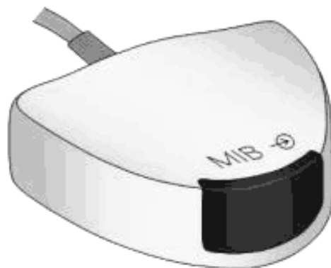
Рисунок D.3 — Настольный инфракрасный порт для ПКС/ТД
