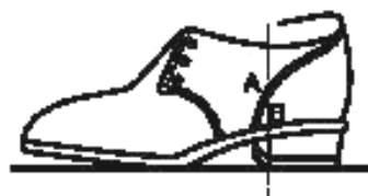
Рисунок 8 — Измерение перекоса накладных задников (задников)
