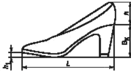
Рисунок 3 — Измерение высоты, длины полуботинок, туфель, высоты каблука и приподнятости носочной части
