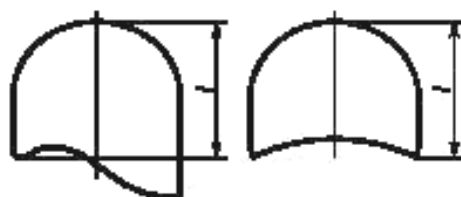
Рисунок 4 — Измерение длины каблука и набойки
