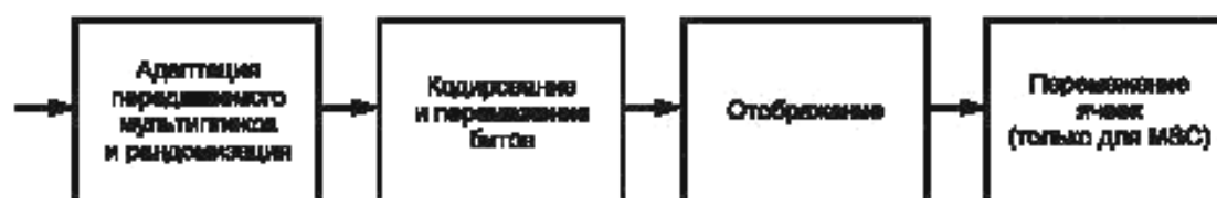
Рисунок 3 — Функциональная блок-схема кодирования и перемежения
