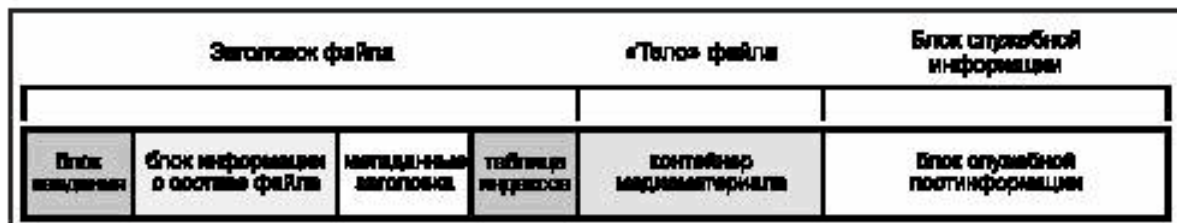
Рисунок П.1 — Основные компоненты простого MXF-файла
