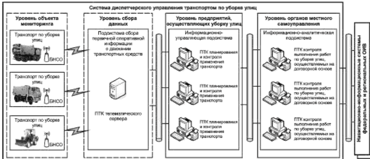
Рисунок 1 — Архитектура системы диспетчерского управления транспортом по уборке улиц
