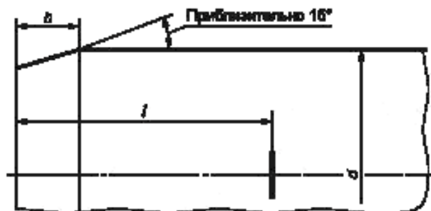
Рисунок 5 — Снятие фаски с конца трубы
