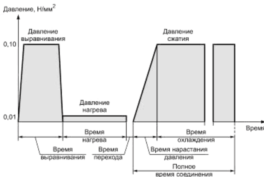
Рисунок 2 — Стадии процесса сварки нагретым инструментом астык
