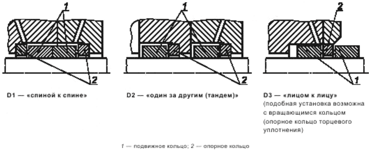
Рисунок F.3 — Примеры компоновок составного торцевого уплотнения
