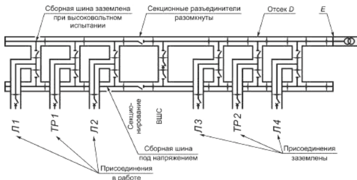
Рисунок Б.8 — Испытания электрической прочности изоляции на месте установки
