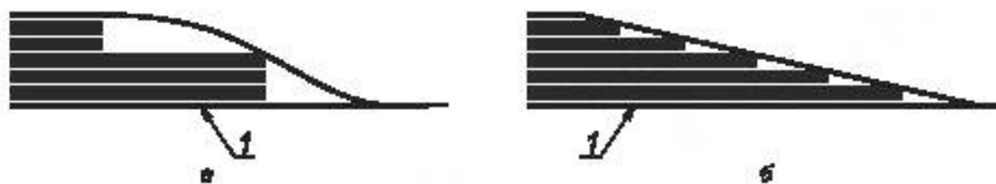
Рисунок А.4 — Рекомендуемая конфигурация границы между металлическими накладками и образцом
