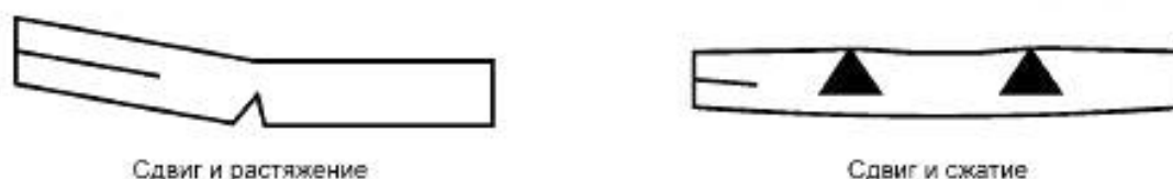
Рисунок Б.5 — Смешанные типы разрушения
