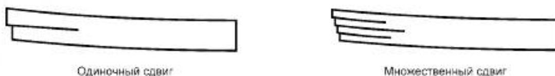
Рисунок Б.4 — Типы разрушений при сдвиге
