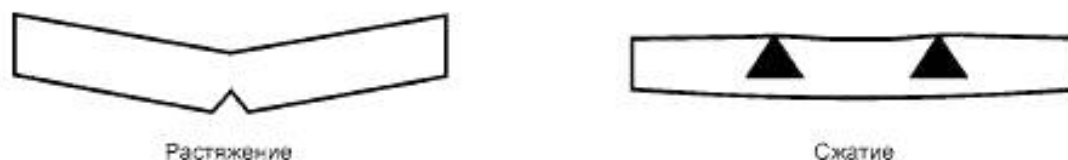
Рисунок Б.6 — Типы разрушения без сдвигов
