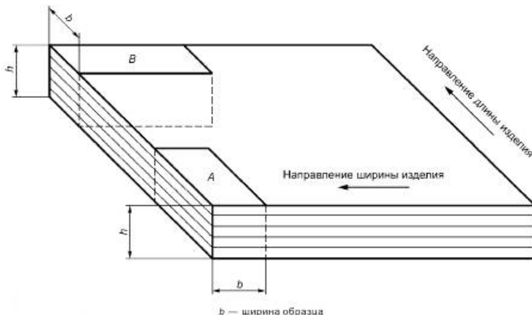
Рисунок Б.3 — Расположение образцов
