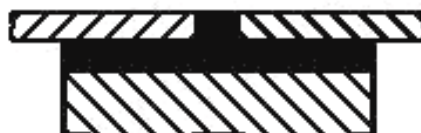
Рисунок А.9 — Пищевая зона. Сплошной непрерывный шов с плоской лицевой поверхностью и накладкой
