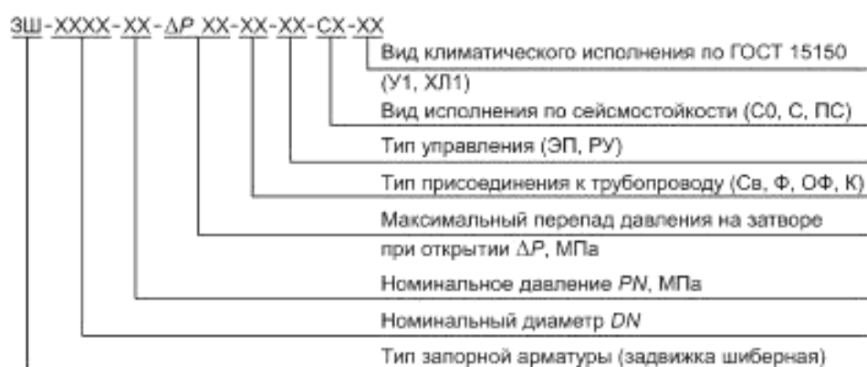
Рисунок 1 — Схема условного обозначения задвижек
