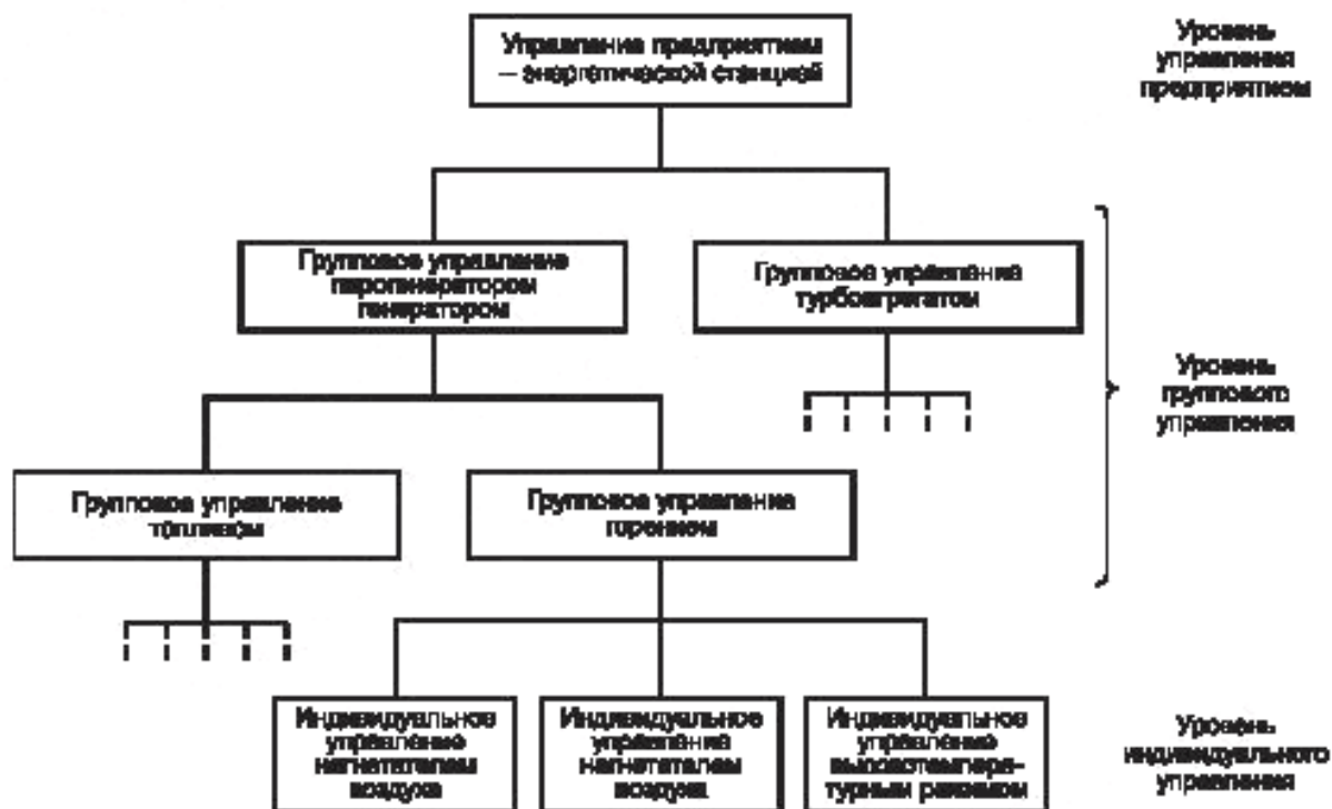
Рисунок А.6 — Уровни управления энергетической станцией (ТЭЦ)
