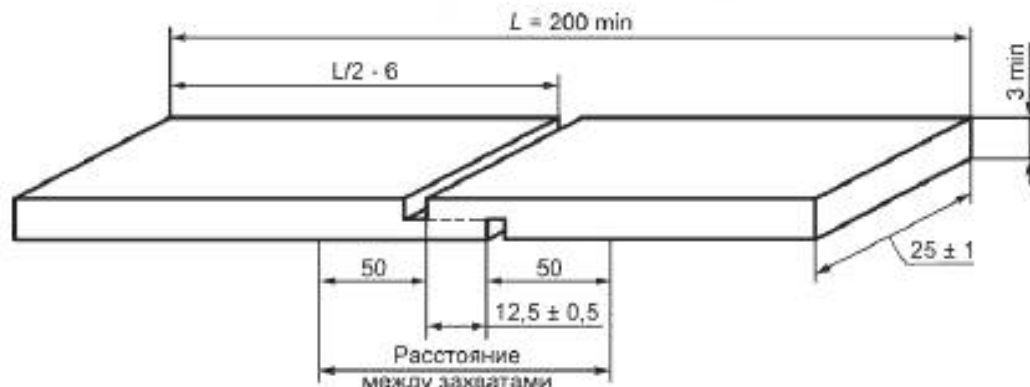
Рисунок 8.7 — Образец для испытания на прочность соединения внахлестку при сдвиге
