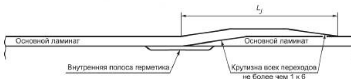
Рисунок И.5 — Основные типы сварных соединений для напорных емкостей без термопластичной футеровки: соединение внахлест основного ламината
