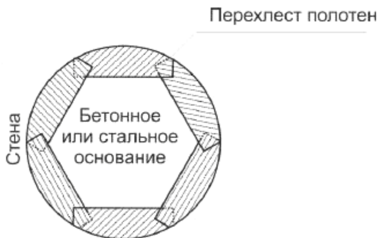
Рисунок А.1 – Укладка стекляного мата первого слоя в примыканиях
