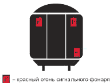
Рисунок 1 — Размещение сигнальных фонарей на торцевых стенах вагона
