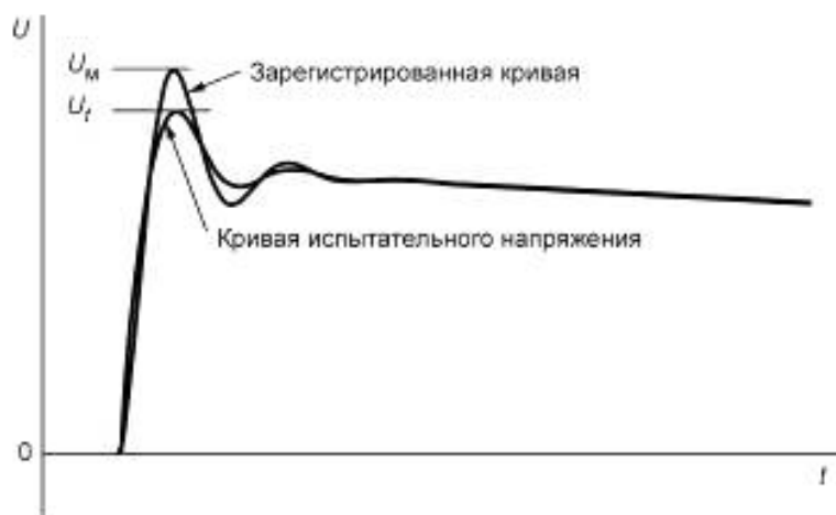
Рисунок Б.3 — Импульс испытательного и зарегистрированного напряжений
