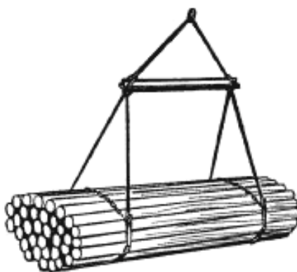
Рисунок 7 — Схема строповки длинномерного груза
