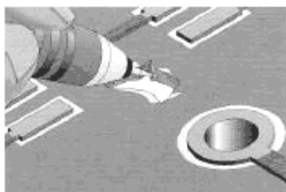
Рисунок 10 а – Удаление поврежденного материала фрезой
