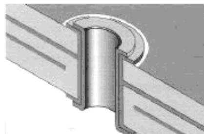
Рисунок 40 б – Завершенный ремонт
