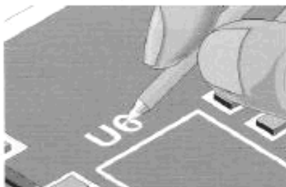
Рисунок 7 с – Нанесение маркировки палочкой, смоченной эпоксидным составом
