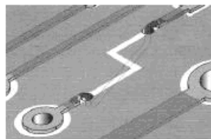
Рисунок 22 d – Припаивание провода к печатному проводнику
