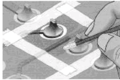
Рисунок 1 б – Нанесение растворителя тампоном для удаления покрытия
