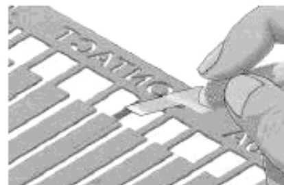
Рисунок 35 б – Удаление клеящей пленки с участка под паяное соединение
