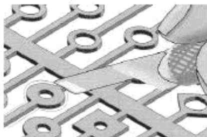
Рисунок 33 а – Удаление поврежденной контактной площадки
