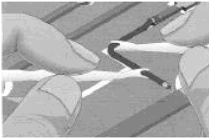
Рисунок 21 с – Придание проводу необходимой формы
