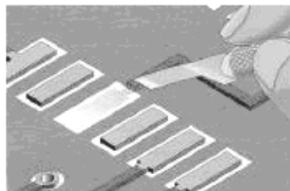
Рисунок 38 б – Удаление паяльной маски
