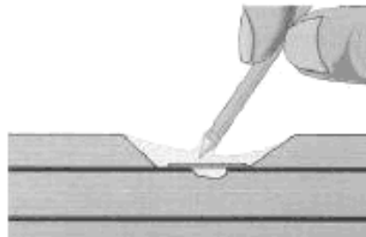
Рисунок 25 d – Покрытие нового соединения эпоксидным составом
