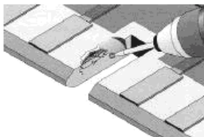
Рисунок 14 а – Удаление поврежденного материала фрезерованием
