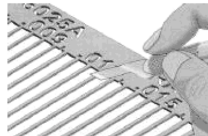
Рисунок 20 d – Отрезание новой перемычки с металлической стороны
