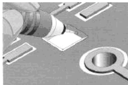
Рисунок 10 б – Выравнивание кромки ручной дрелью или надфилем
