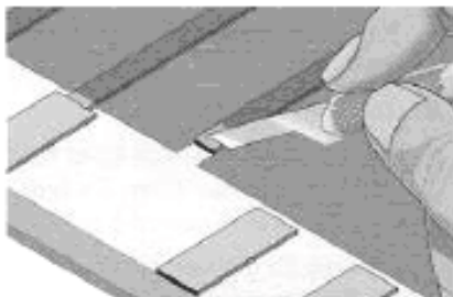
Рисунок 35 а – Удаление поврежденного концевого контакта
