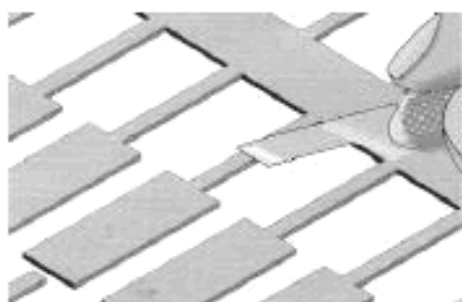
Рисунок 37 с – Вырезание новой контактной площадки
