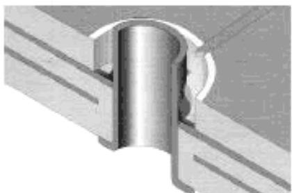
Рисунок 41 с – Заполнение вскрытого отверстия эпоксидной смолой
