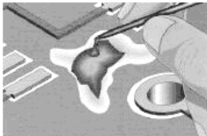
Рисунок 9 с – Нанесение эпоксидного клея деревянной палочкой
