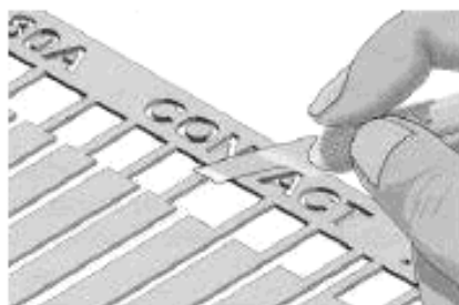
Рисунок 35 с – Вырезание нового концевого контакта
