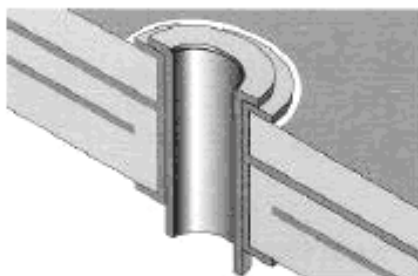
Рисунок 40 а – Установка пистона в отверстие
