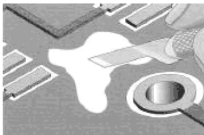
Рисунок 9 а – Удаление поврежденного материала
