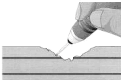
Рисунок 25 а – Фрезерование многослойной печатной платы для вскрытия поврежденных печатных проводников
