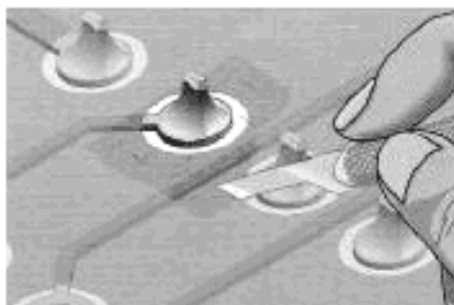
Рисунок 4 а – Отделение поврежденного или нежелательного покрытия
