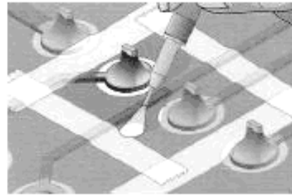
Рисунок 5 б – Удаление покрытия микроструйной системой
