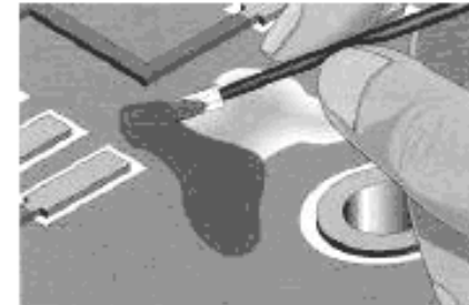
Рисунок 9 д – Создание текстуры поверхности пористым тампоном
