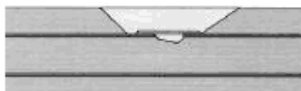
Рисунок 25 е – Завершенный ремонт
