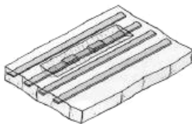
Рисунок 24 г – Припаивание сменного проводника
