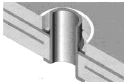
Рисунок 41 б – Подlayка втулки пистона к вскрытому внутреннему слою
