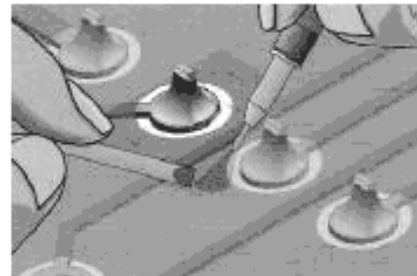
Рисунок 3 б – Удаление отвержденного покрытия с обрабатываемого участка
