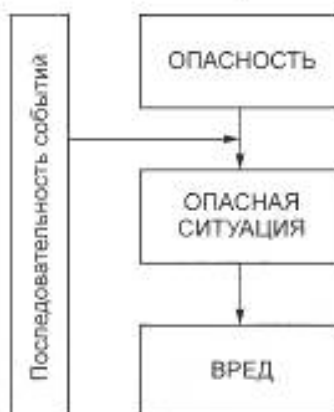
Рисунок А.1 — Взаимосвязь между последовательностью событий, ВРЕДОМ и ОПАСНОСТЬЮ
