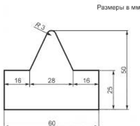
Рисунок 2 — Поперечный профиль и размеры бойка
