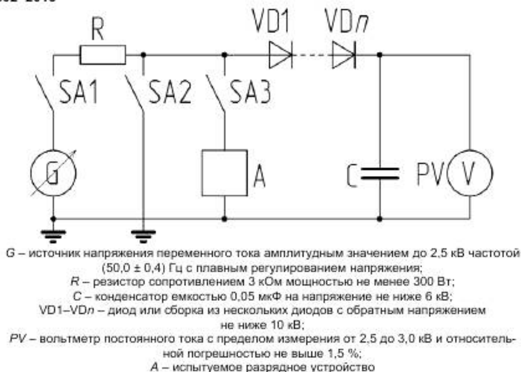
Рисунок 1 – Схема для проверки напряжения срабатывания разрядного устройства
