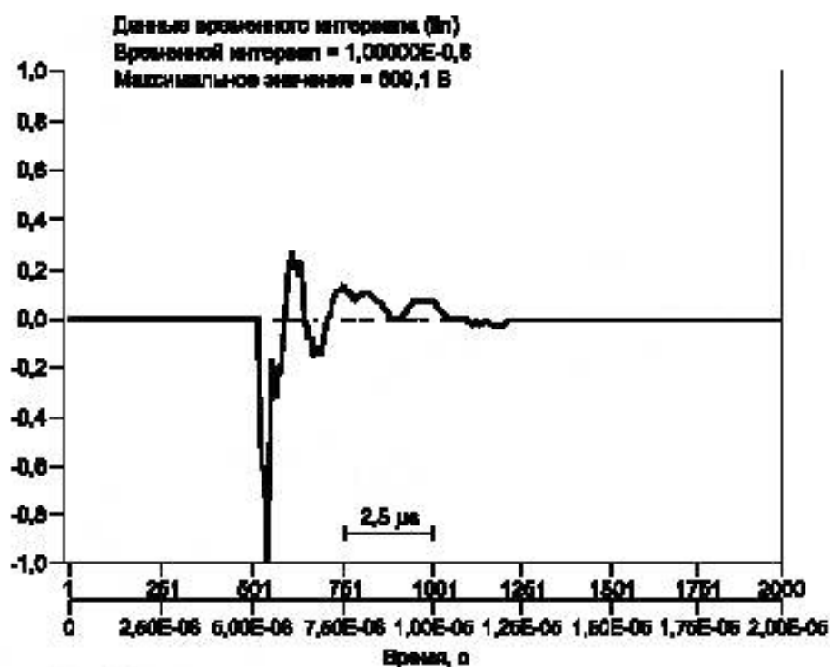
Рисунок 15 — Пример высокочастотного импульса коммутационного перенапряжения
