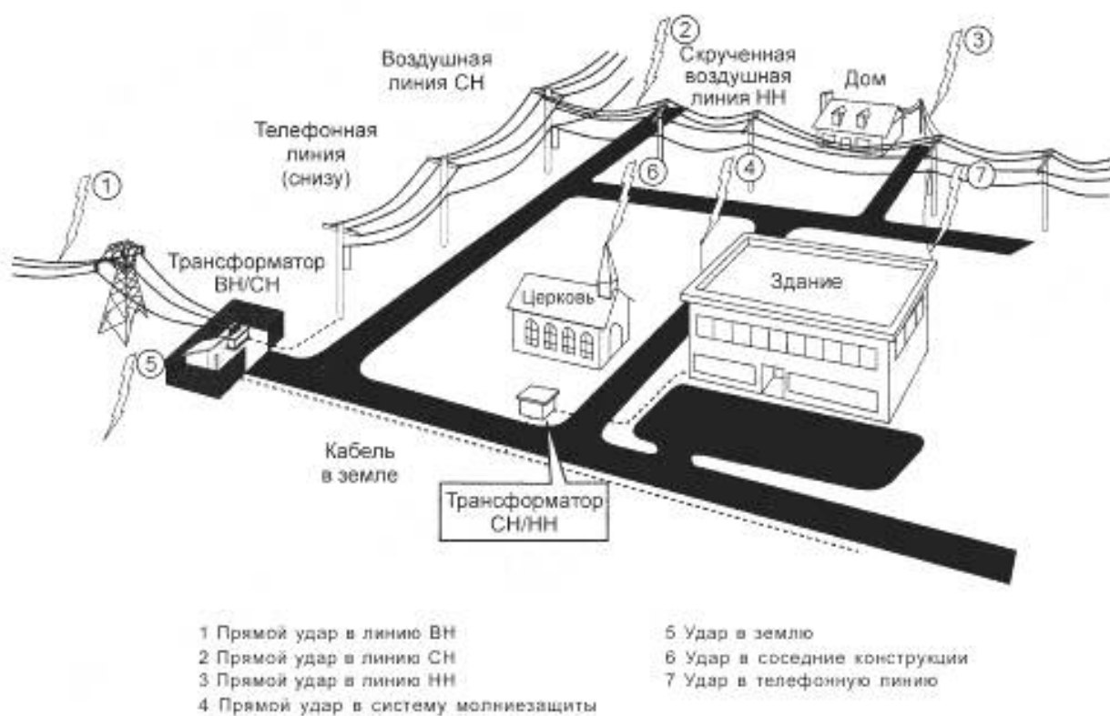
Рисунок 2 — Примеры удара молнии в сложной электрической системе
