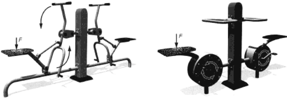
Рисунок E.3 — Примеры приложения нагрузки
