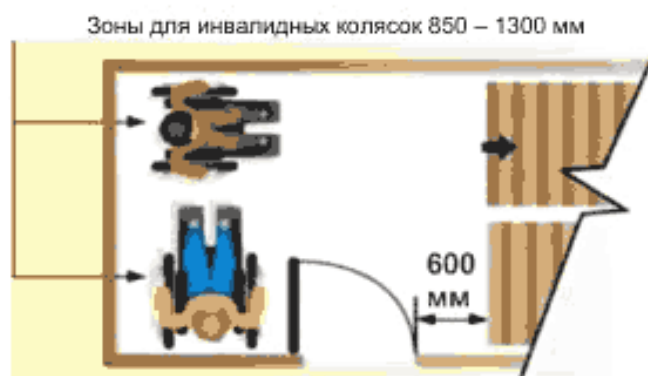
Рисунок 10 – Зона оказания помощи при эвакуации
