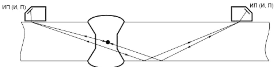
Рисунок 3 — Эхо-теневого прямым (а) и наклонными (б) ПЭП
