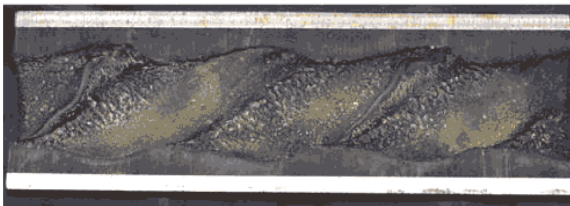
Рисунок I.10 — Рваный /разбитый статор
