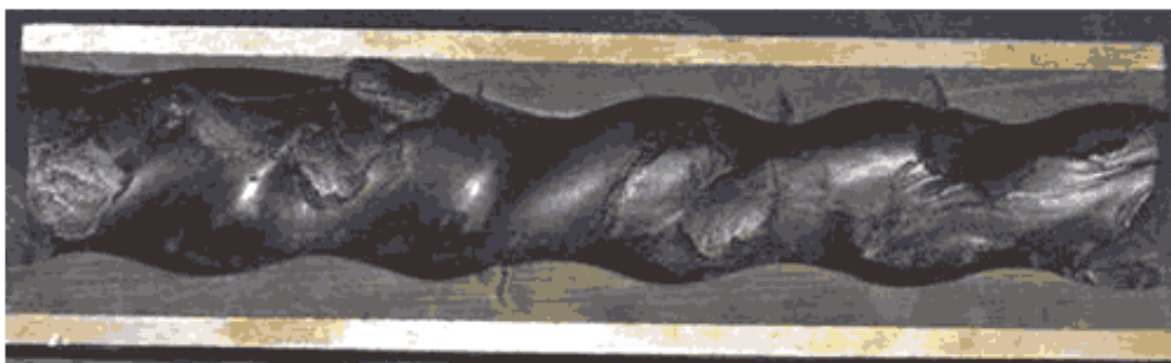
Рисунок I.10 — Рваный /разбитый статор
