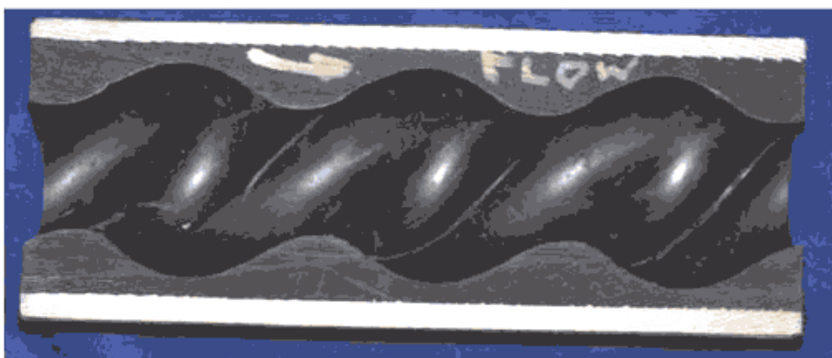
Рисунок 1.7 — Эродированный/ вымытый в результате интенсивной эксплуатации
