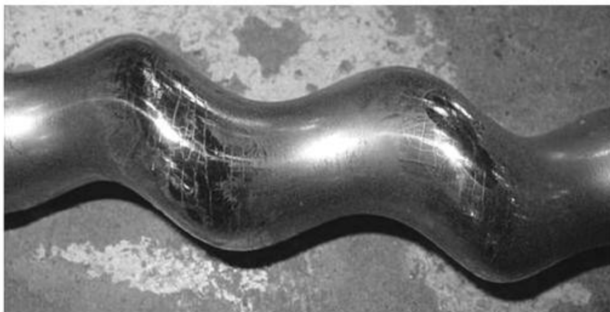
Рисунок 1.3 — Растрескивание/ термическое растрескивание
