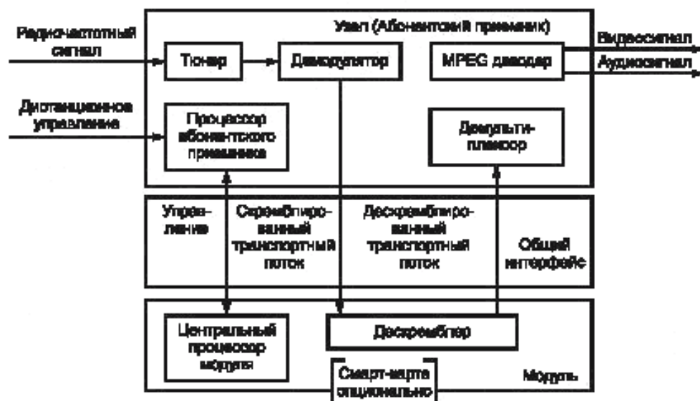
Рисунок 1 — Структурная схема приемного оборудования СОД
