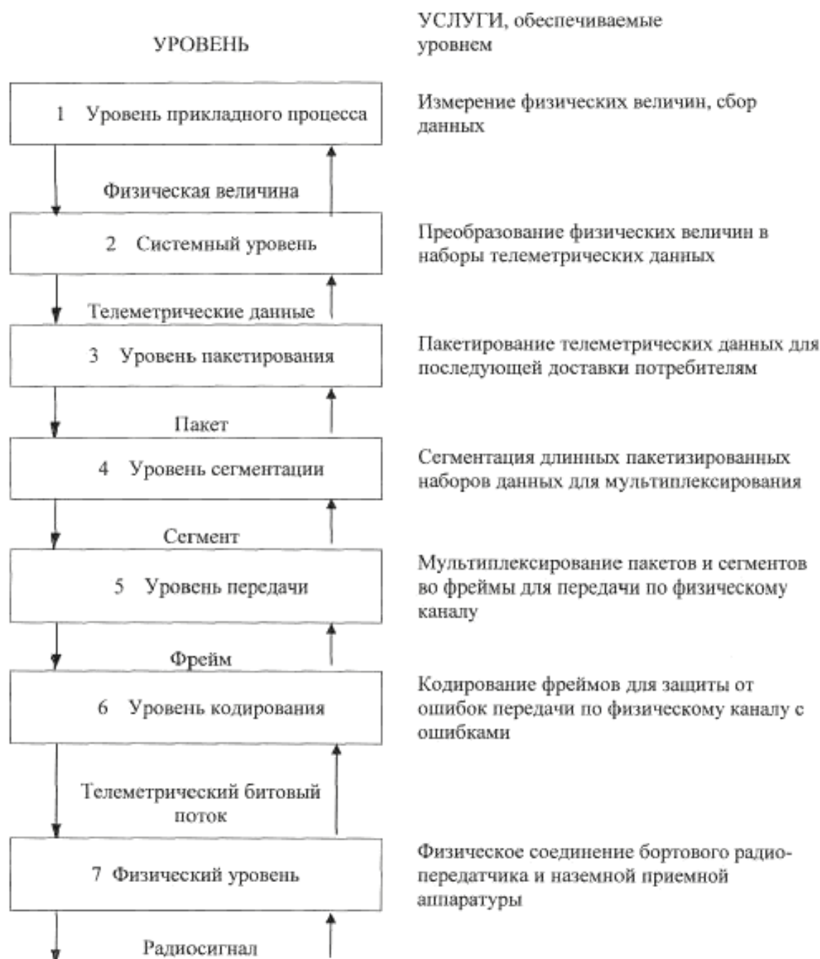
Рисунок 1 — Иерархическая модель телеметрической системы, использующей рекомендации CCSDS
