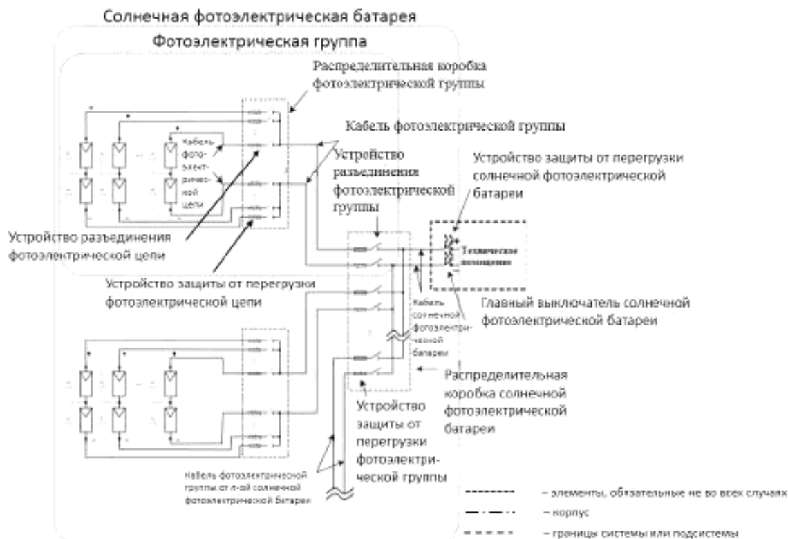
Рисунок 12 — Схема солнечной фотоэлектрической батареи — случай с несколькими цепями батареи, разделенной на группы
