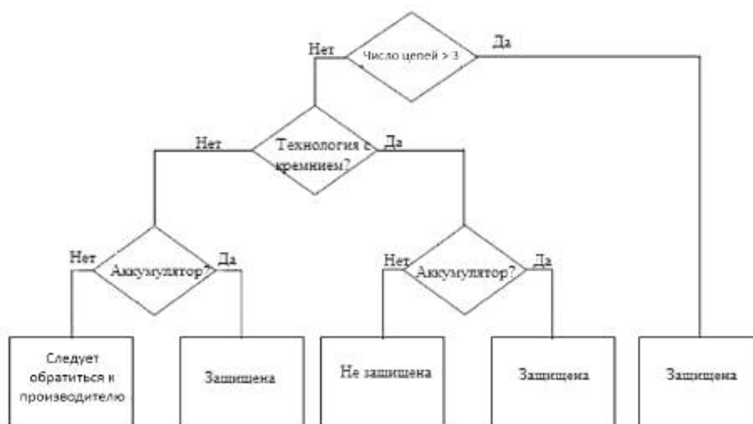
Рисунок 13 — Требования по максимальной токовой защите в фотоэлектрической цепи
