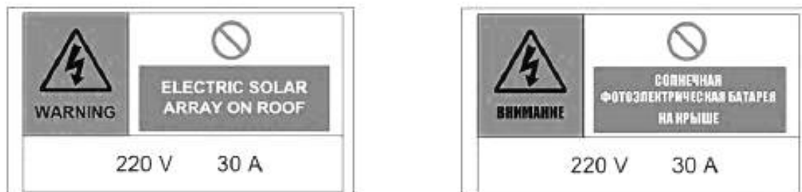
Рисунок Г.3 — Примеры знака, информирующего об опасности возникновения пожара на главном распределительном щите здания (см. 10.5.1)
