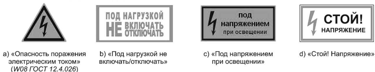
Рисунок ДА.3 — Примеры знаков, указывающих на то, что любой компонент ФБ может находиться под напряжением в любой момент времени независимо от того, разомкнуты или не разомкнуты выключатели в ФБ
