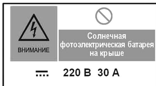
Рисунок ДА.6 — Пример предупреждающего знака на главном распределительном щите объекта и идентичный знак МЭК для случая, когда ФБ расположена на крыше
