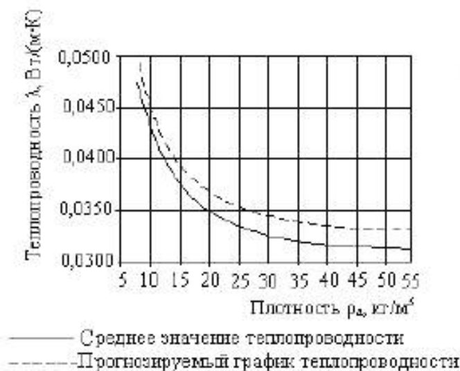
Рисунок В.2 – Зависимость теплопроводности от плотности (косвенный метод) [толщина материала 50 мм; средняя температура 10 °С; (1 - a) = 0,90 ; n = 3873 ]
