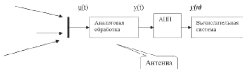
Рисунок 1 – Основные этапы обработки информации с помощью электромагнитных волн
