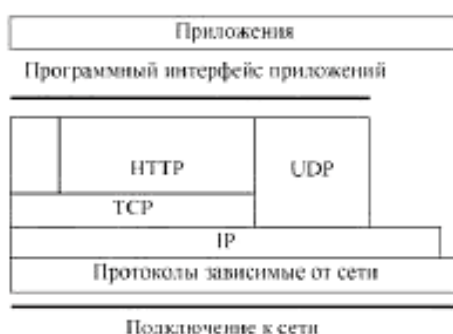
Рисунок 2 — Стек протоколов интерактивного канала
