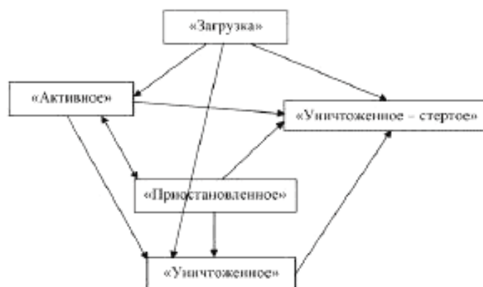
Рисунок 7 — Диаграмма состояний и переходов между ними
