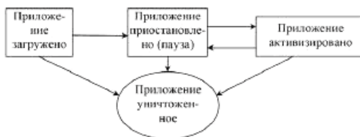
Рисунок 5 — Модель состояний виртуальной машины Xlet
