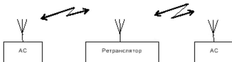
Р и с у н о к 4.3 — Структурная схема организации подвижной радиосвязи с использованием ретранслятора сигналов
