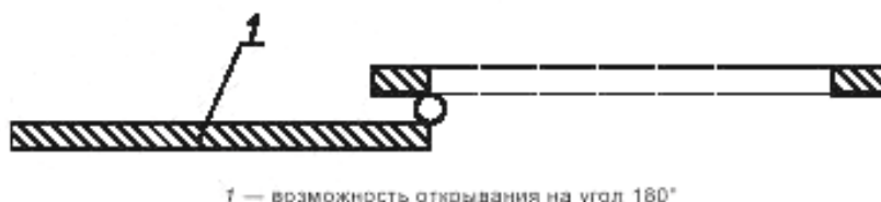
Рисунок Д.2 — Испытание доводчиков для дверей одностороннего открывания
