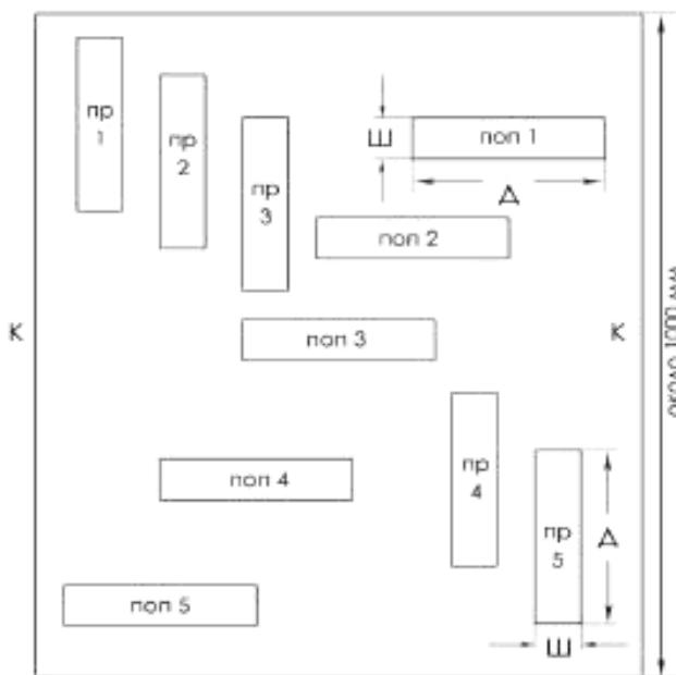
Условные обозначения: пр — пробы, вырезанные в продольном направлении; поп — пробы, вырезанные в поперечном направлении; К — кромка; Д — длина пробы; Ш — ширина пробы;
