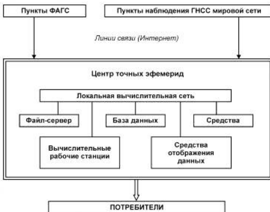
Рисунок 1 — Схема центра точных эфемерид
