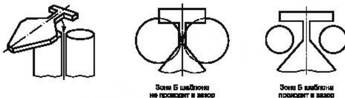
Рисунок 7.8 — Испытания прямоугольных зазоров с использованием зоны Б шаблона
