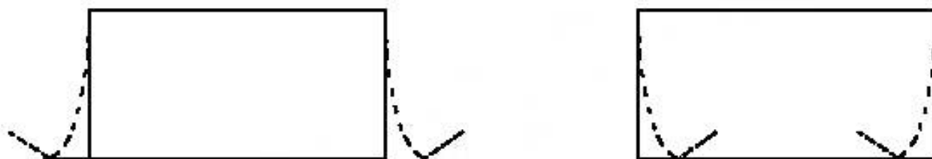
Рисунок 14 — Потеря устойчивости сечения простой формы
