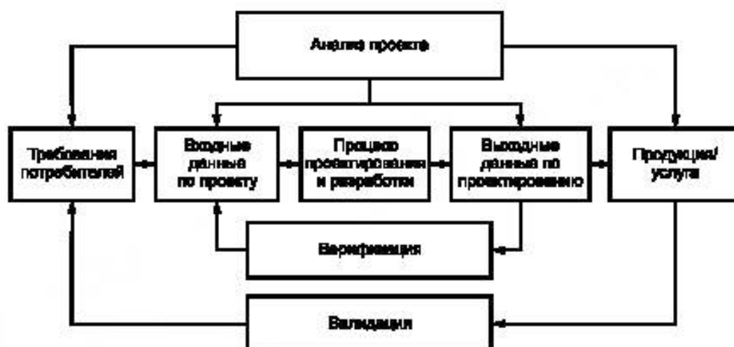
Рисунок 1 — Схема взаимосвязи анализа, верификации и валидации при проектировании и разработке продукции и/или услуги
