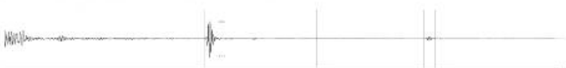
Рисунок 3 — Типовая осциллограмма продольных импульсов
