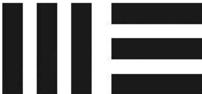
Рисунок 2 — Тест-объект для проверки разрешающей способности
