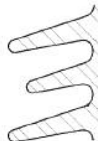
Рисунок 5б — Длинностержневые, опорные и полые изоляторы с переменным вылетом ребра
