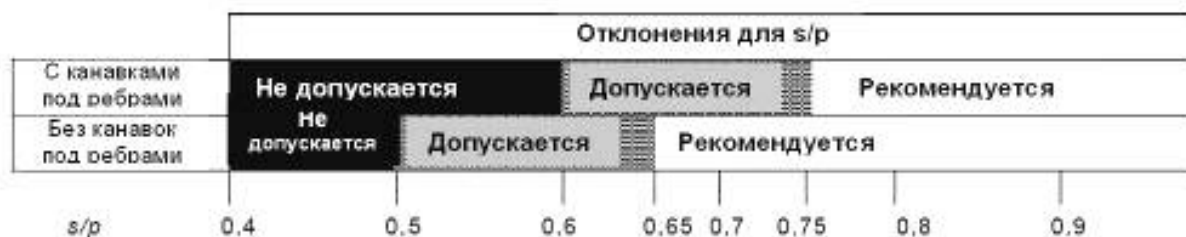
Рисунок 9 — Зависимость межреберного расстояния от вылета ребра( s/p )
