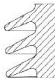
Рисунок 4б — Противотуманные изоляторы с крутым наклоном ребра — длинностержневые, опорные и полые изоляторы
