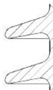
Рисунок 2б — Стандартный профиль ребра — длинностержневые, опорные и полые изоляторы
