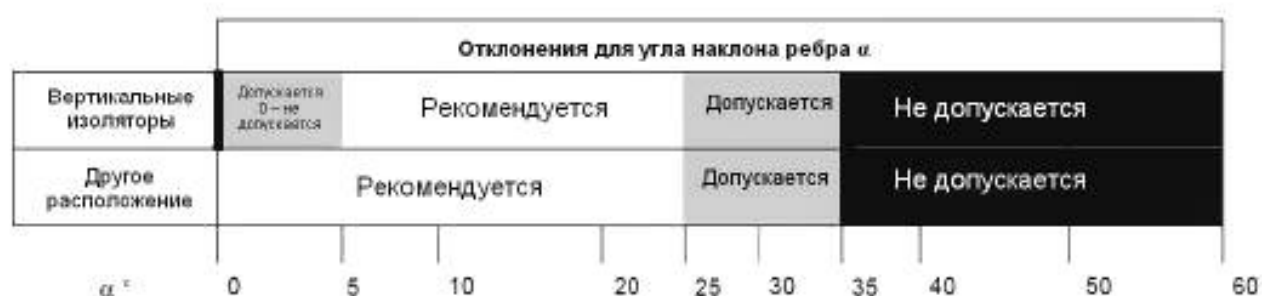
Рисунок 146 — Рекомендации по выбору угла наклона ребра
