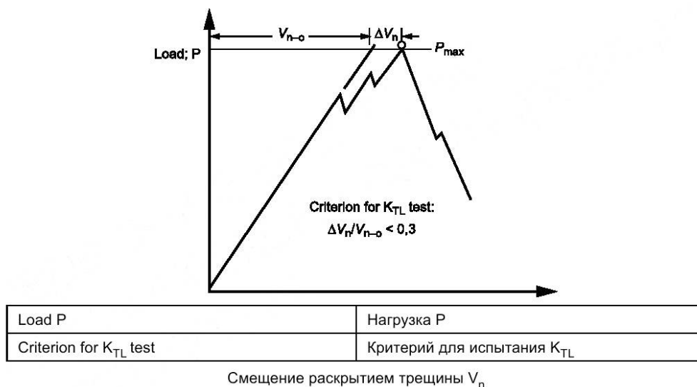
Рисунок 3 — Типовой график зависимости нагрузки от смещения раскрытием трещины
