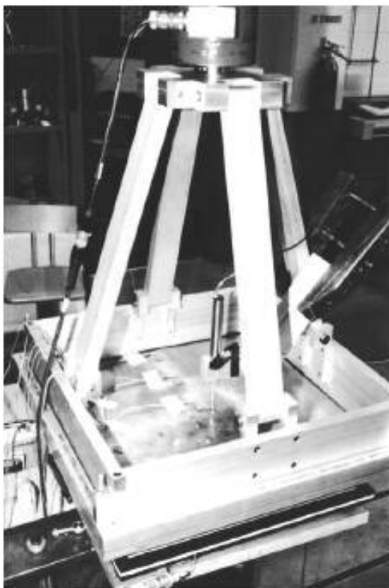
Рисунок 4 — Датчик силы и устройство нагружения панели со стальной калибровочной пластиной
